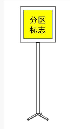
图4 柱式危险废物贮存分区标志设置示意图
